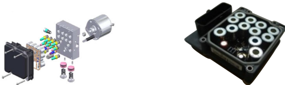
(a) Composants de l'ESC. Le circuit hydraulique de freinage passe dans le bloc d'aluminium. (b) Carte électronique et solénoïdes. C'est la partie de l'ESC utilisée sur banc HIL.
